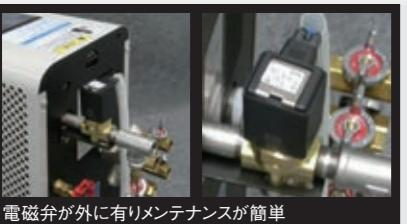
電磁弁が外に有りメンテナンスが簡単
