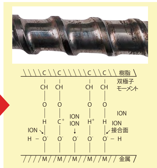
洗浄剤添加後の樹脂-金属面モデル
